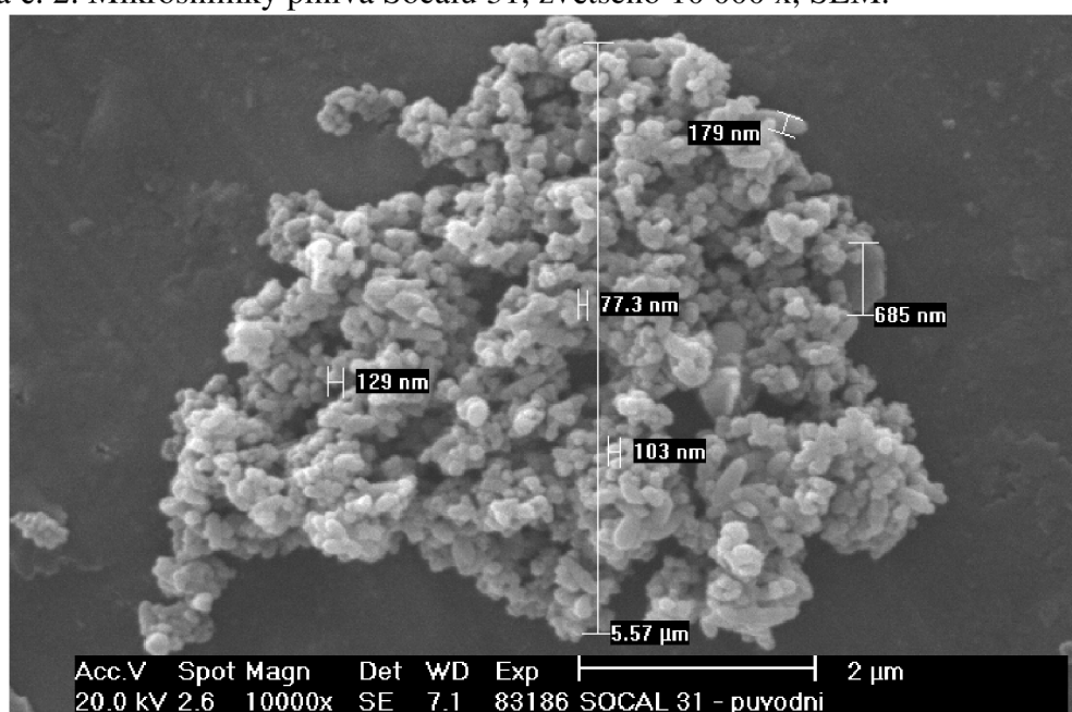
Příloha č. 2: Mikrosnímky plniva Socalu 31, zvětšeno 10 000 x, SEM.
