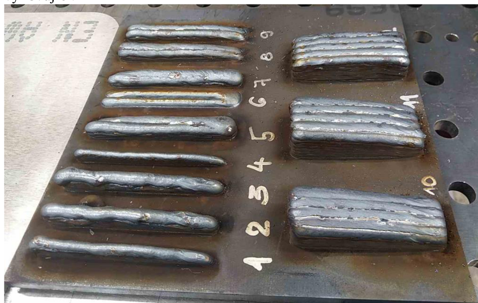
Obr.18 Ukázka objemového 3D tisku kovů WAAM metodou CMT [47]
