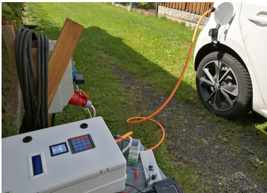
Obrázek 5.4: Master stanice se simulovanou Slave stanicí
