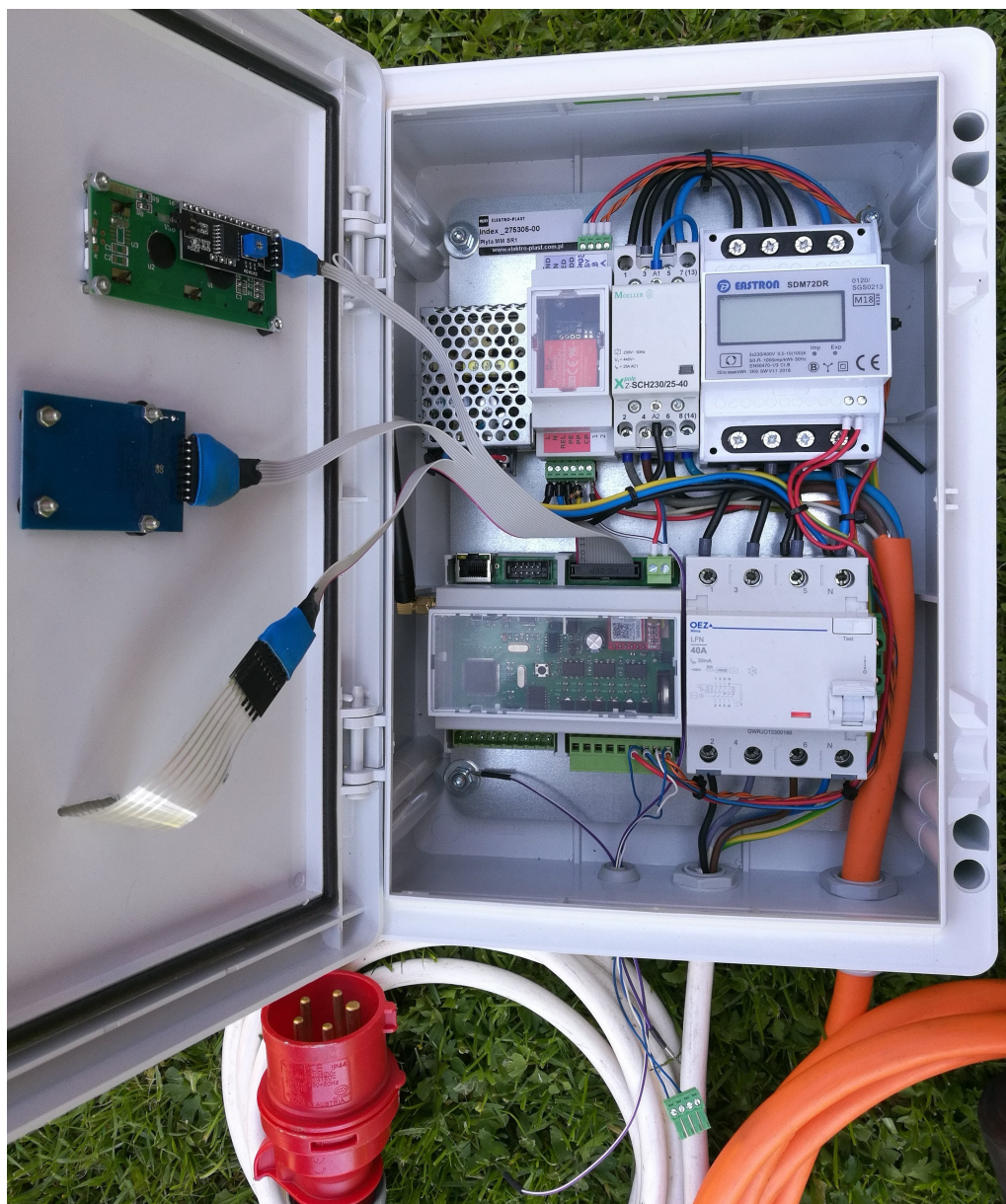
Obrázek 5.3: Komponenty uvnitř Master nabíjecí stanice
