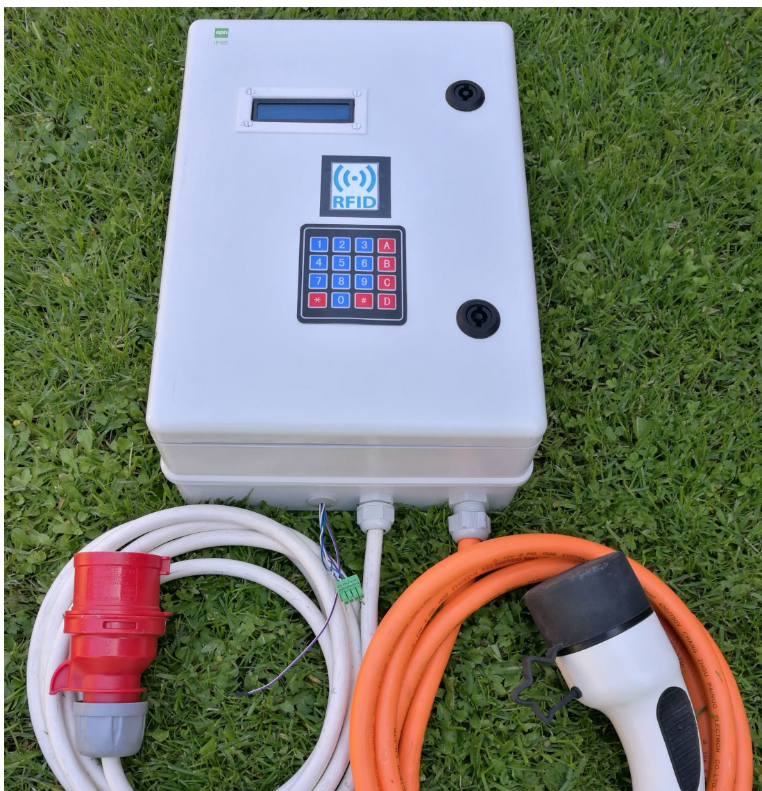
Obrázek 5.1: Master nabíjecí stanice v nástěnné skříňce
