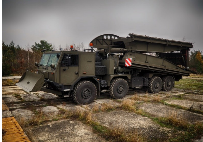
Obr. 2.7 Mostní vozidlo AM-70 EX
