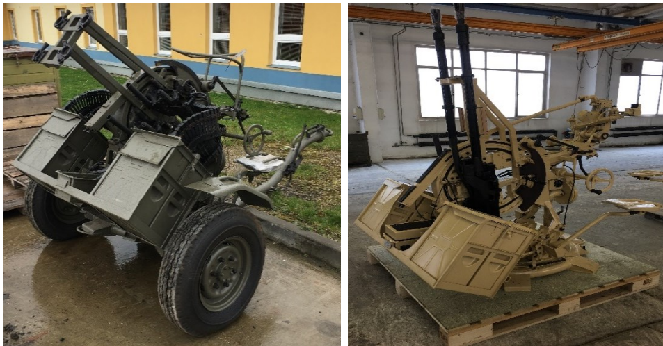
Obr. 2.8 Dvojkulomet MR-2 před a po generální opravě
