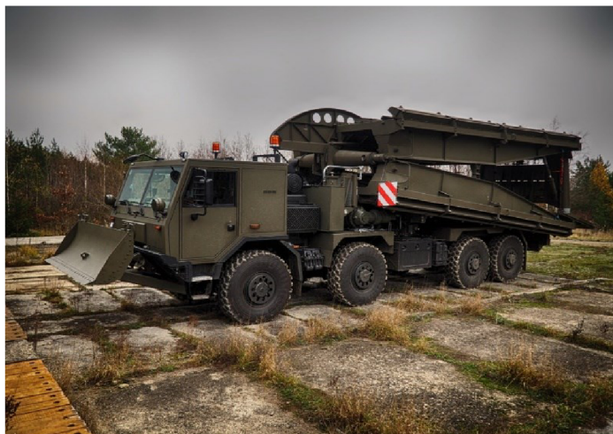
Obr. 2.7 Mostní vozidlo AM-70 EX
