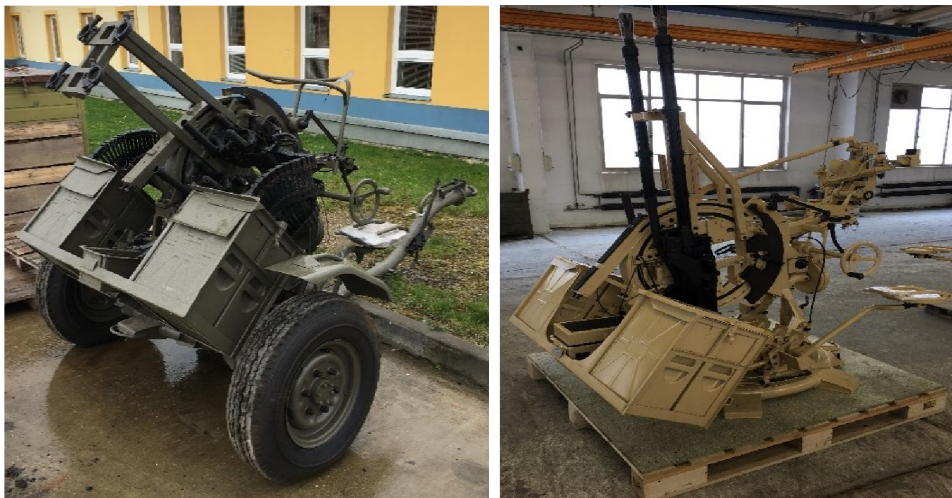
Obr. 2.8 Dvojkulomet MR-2 před a po generální opravě
