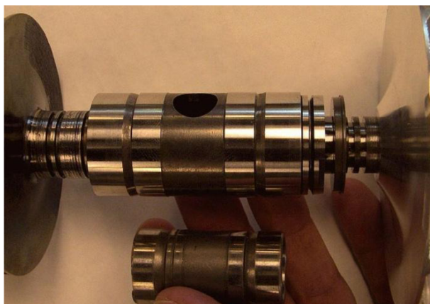
Obr. 20 Montáž kuličkových ložisek[13]
