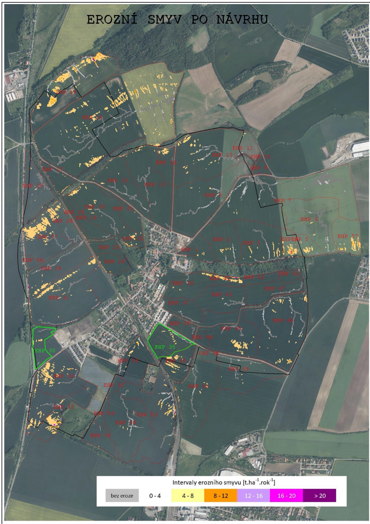
Obr. 49: Analýza vodní eroze pomocí výpočtu rovnice USLE, stav po návrhu, zpracováno v Atlasu DMT
