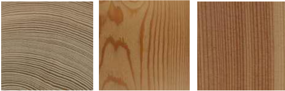
Obrázek 2: příčný, tangenciální a radiální řez dřevem modřínu
