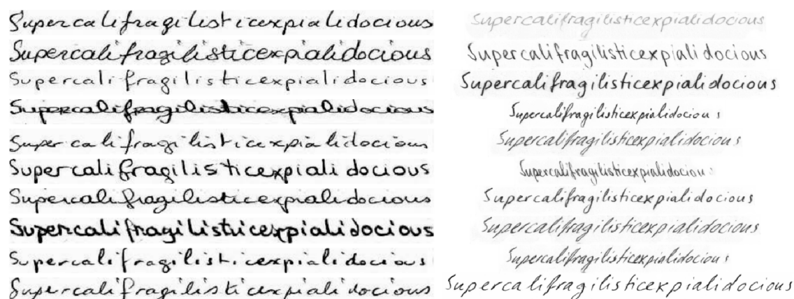
Obrázek 3.12: Srovnání vygenerovaného písma modelů ScrabbleGAN [10] (vlevo) a modelu lineGen [7] (vpravo). Zatímco první zmíněný model má pro každý znak vstupní sekvence stejně širokou oblast ve výstupním obrázku, tak druhý model volí tuto šířku dynamicky. Obrázek převzat z [7].
