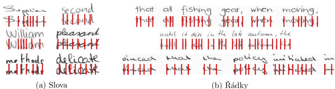
Obrázek 4.7: Ukázka výsledků automatické anotace pozic znaků ve slovech a řádcích z datové sady IAM [29] pomocí natrénovaného OCR modelu s chybovou funkcí CTC loss [13]. Červené linky vyznačují predikovanou horizontální pozici. Vlevo (a) jsou znázorněny ukázky odhadů pozic pro samostatná slova a vpravo (b) jsou příklady určení pozic znaků na řádcích.
