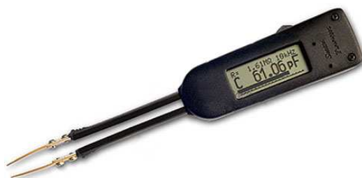
Obr. 25: Měřící pinzeta SMT Smart Tweezers (podle [18])
