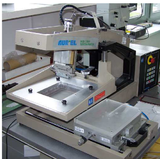
Obr. 8: Poloautomatická sítotisková stanice
