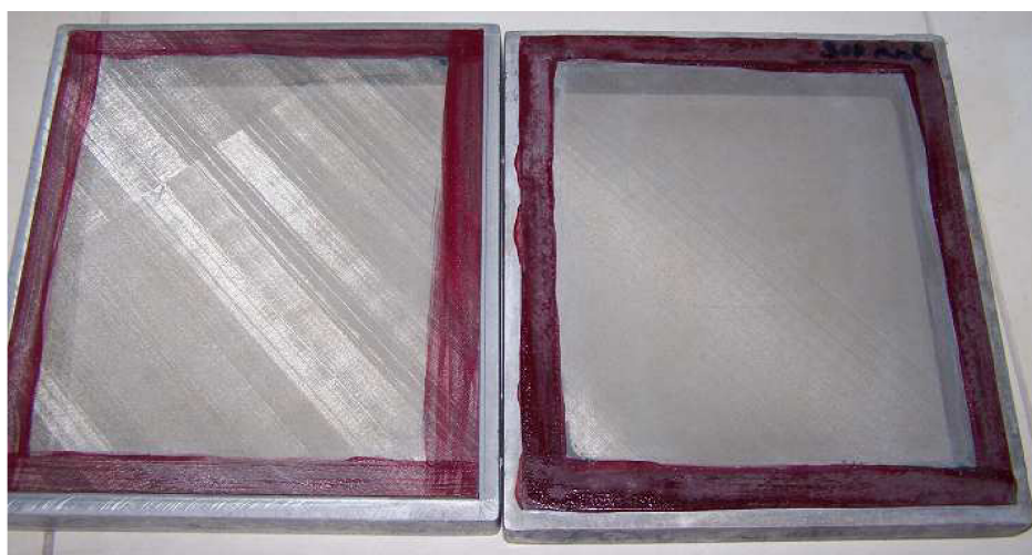
Obr. 6: Síta s polyesterovým vláknem
