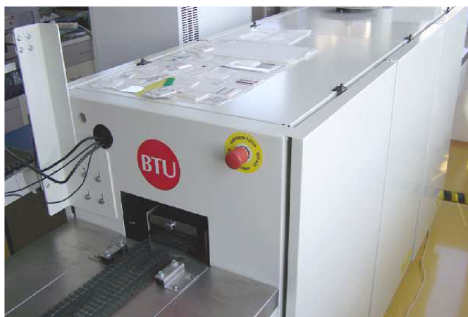
Obr. 12: Průběžná pec BTU International
