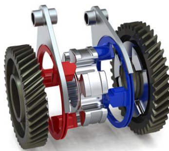
Obr. 9 Řadící spojky Zeroshift [9]
