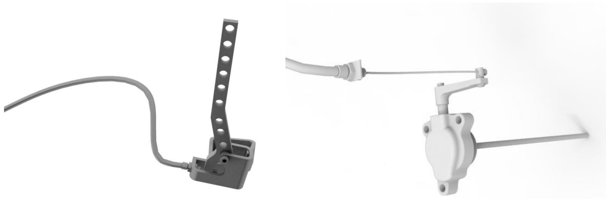
Obr. 22 Ovládání mechanické spojky (nalevo rukojeť s uložním, napravo pákový mechanismus mechanické vačky)
