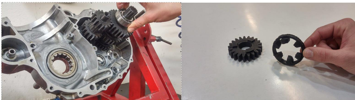
Obr. 61 Plastový prototyp převodovky Zeroshift v motoru Husqvarna FE 501
