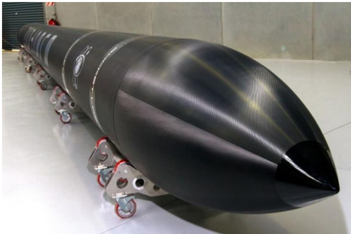
Obr. 6. 2 Uhlíková kompozitní raketa Electron [53]
