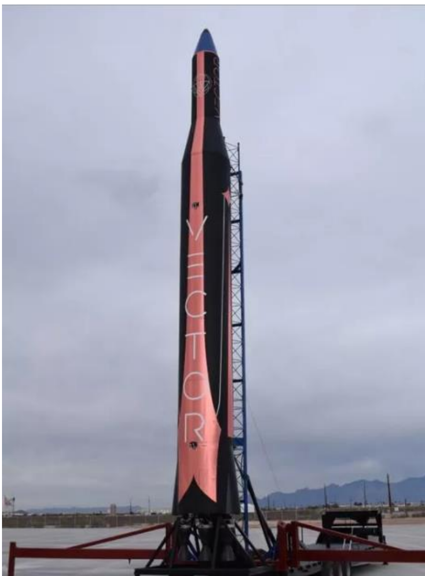
Obr. 6. 5 Nosná raketa Vector-R a její mobilní startovací zařízení [58]
