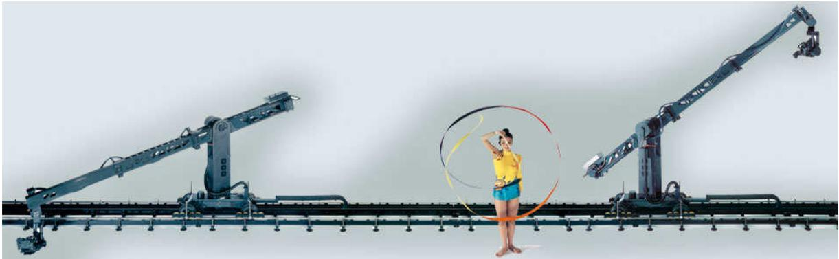
Obrázok 3.5: Teleskopické kamerové rameno založené na systéme Techno 15 Technocrane od firmy Supertechno.
