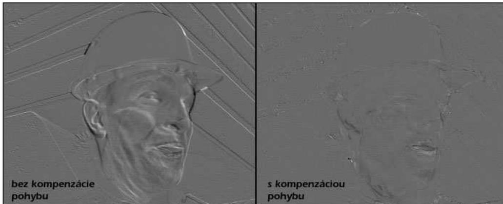
Obrázok 4.2: Znázornenie vplyvu použitia kompenzácie pohybu na obsah rozdielového snímku.
