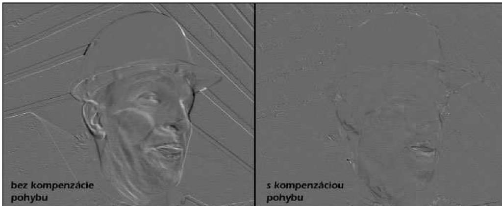
Obrázok 4.2: Znáznornenie vplyvu použitia kompenzácie pohybu na obsah rozdielového snímku.
