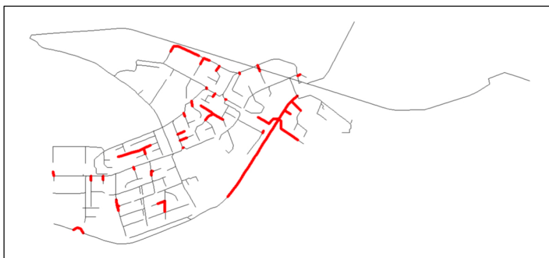
Obr.9 - Vyhodnocení přetížení stokové sítě jednotné soustavy pro P = 1 (N=1) z 22.7.1995 (Zdroj: Generel odvodnění hl. m. Prahy – dílčí projekt, detailní fáze pro území Hlubočepy – Holyně )
