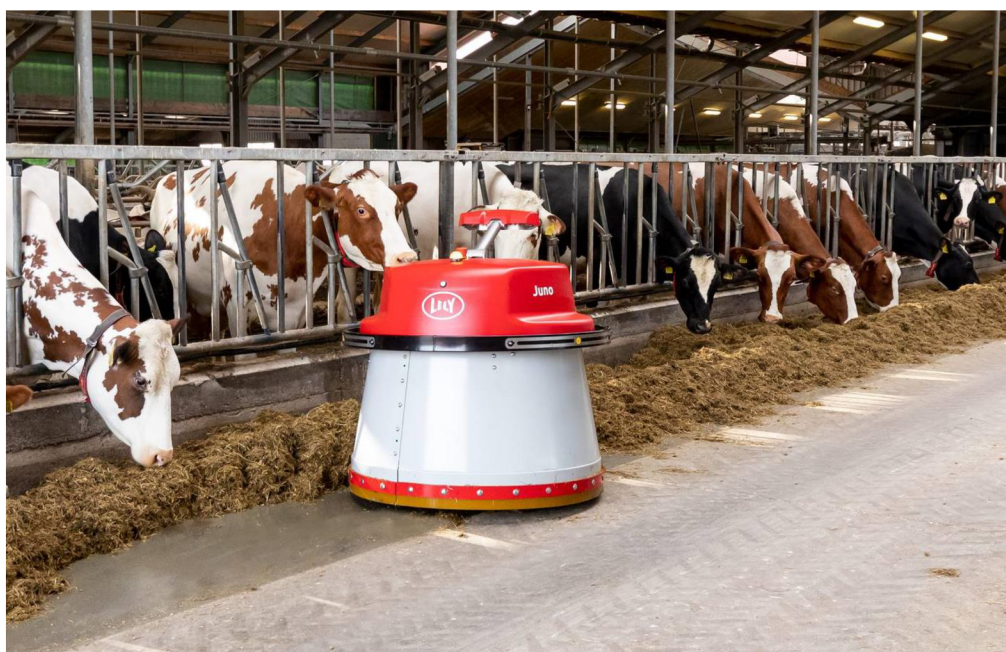
Obrázek 10 Automatický krmný přihrnovač Lely Juno (Zdroj: [7])
