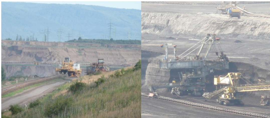
Obr.č.,61,62. Současný stav lomu Šverma-Vršany, s velkostroji a pasovými dopravníky na vytěžené uhlí, těžební strana povrchového dolu (Nestlerová 9/2010).
