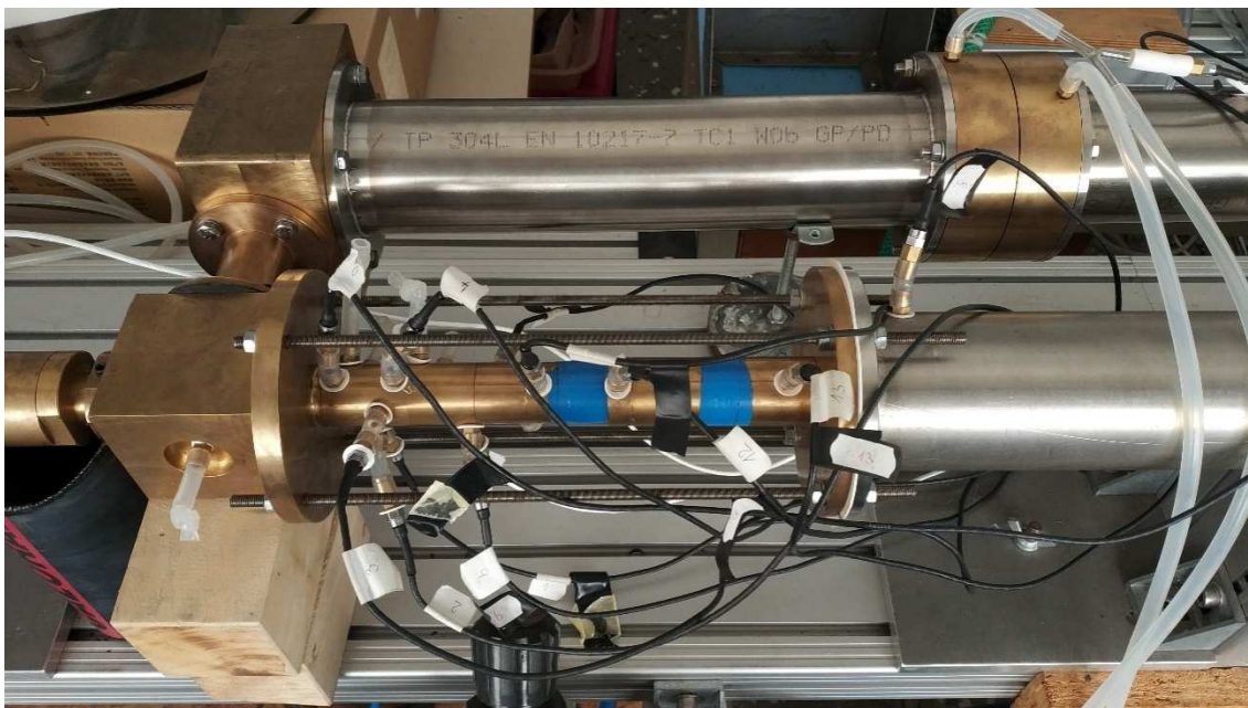
Obr. 4: Ejektor sestavený v laboratoři
