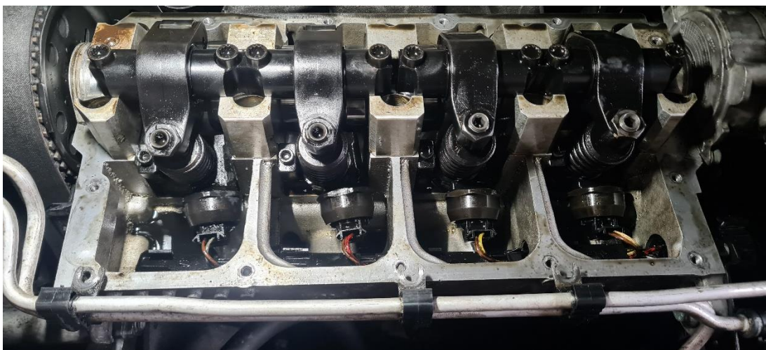
Obrázek 4.3 – Hlava motoru po demontáži víka motoru
