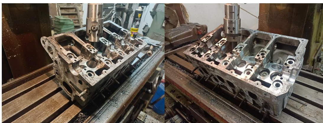
Obrázek 4.10 - Frézování otvoru pro vložku
