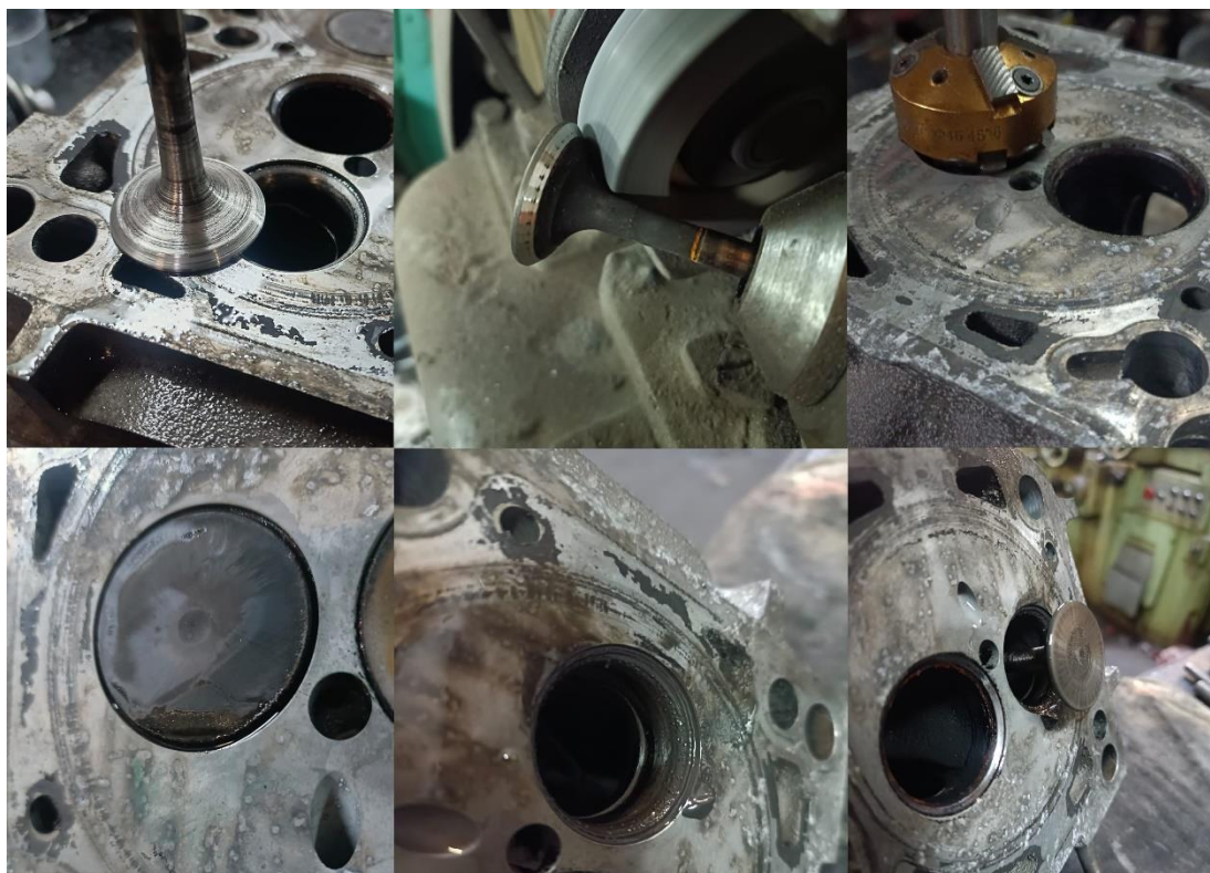
Obrázek 4.16 - Oprava ventilu a sedel v hlavě válců
