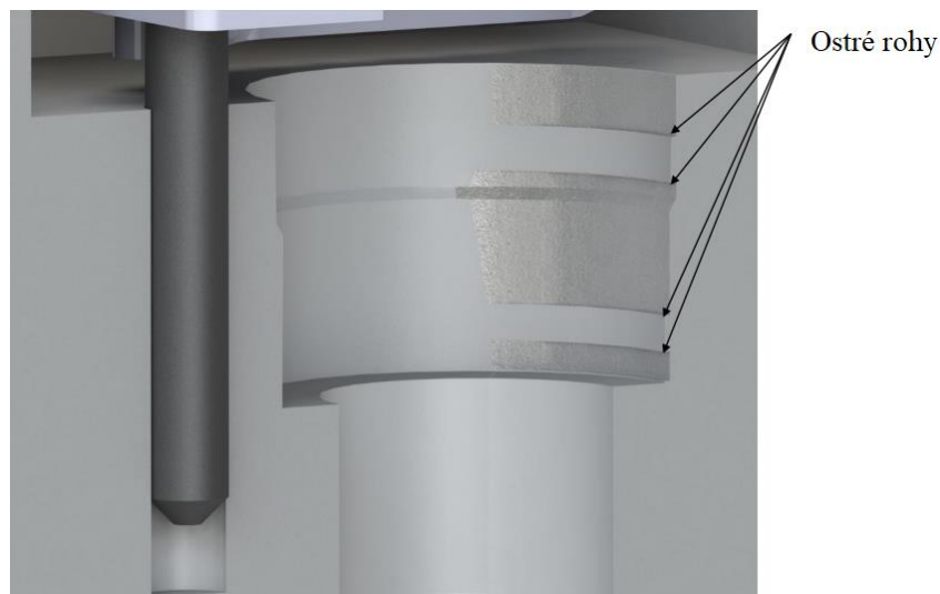
Obrázek 5.2 - Poškození hlavy válců (Pumpe-Düse Reparatur, 2021)
