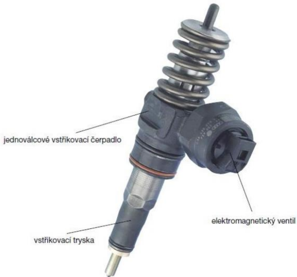
Obrázek 1.3 - Sdružená vstříkovací jednotka (Sdružené vstříkovací jednotky, 2014)
