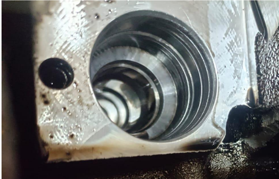
Obrázek 4.5 - Vymačkané sedlo jednotky čerpadlo tryska
