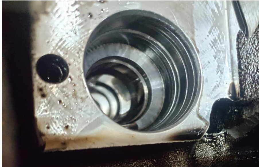
Obrázek 4.5 - Vymáčkané sedlo jednotky čerpadlo tryska
