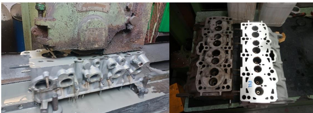
Obrázek 4.14 - Hlava válců pro broušení
