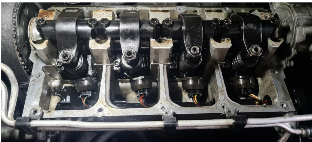
Obrázek 4.3 – Hlava motoru po demontáži víka motoru
