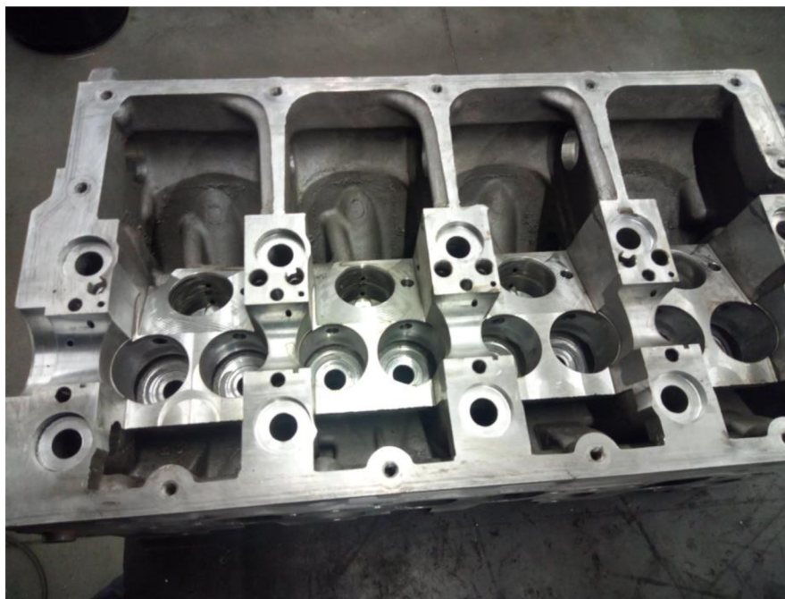
Obrázek 4.9 – Odstrojená a umytá hlava motoru
