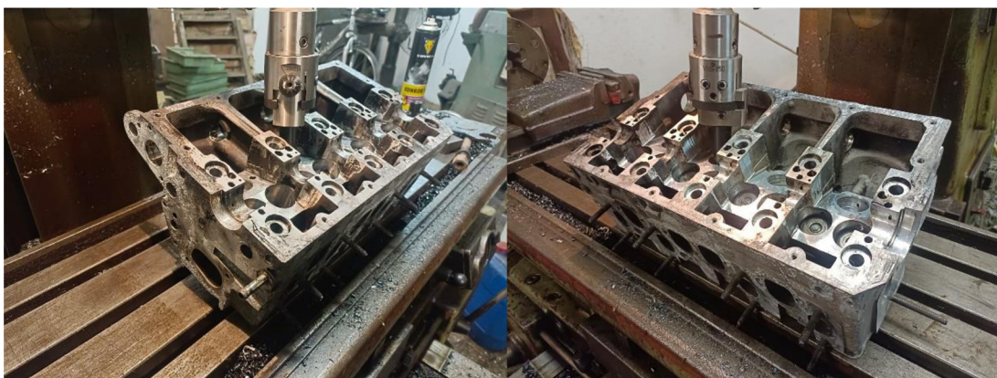
Obrázek 4.10 - Frézování otvoru pro vložku
