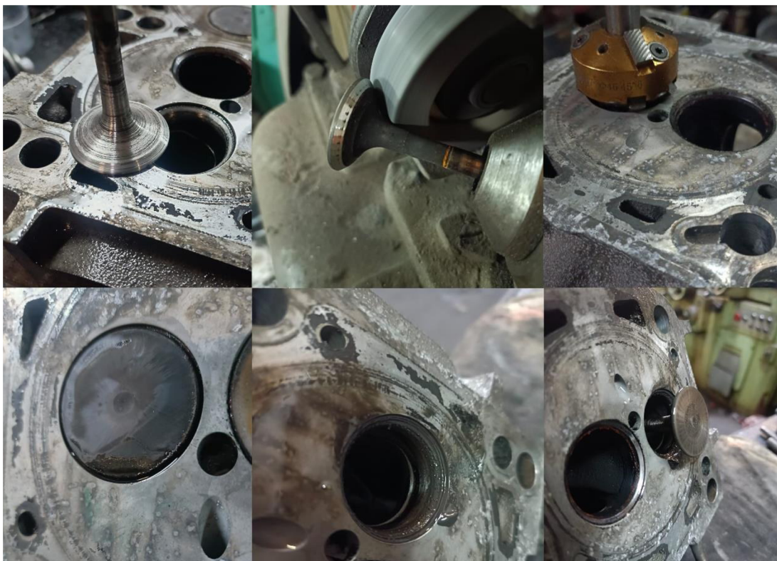
Obrázek 4.16 - Oprava ventilu a sedel v hlavě válců
