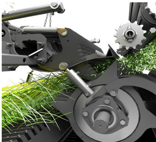
Obrázek 3.6 Horní plnění a uložení nožů (Poettinger.at, 2024)
