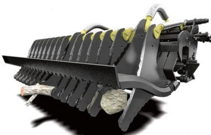
Obrázek 3.7 Jištění nožové soustavy (Poettinger.at, 2024)
