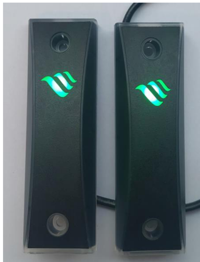
Obrázek 31 - čtečka Promag UR220U (zdroj: vlastní)
