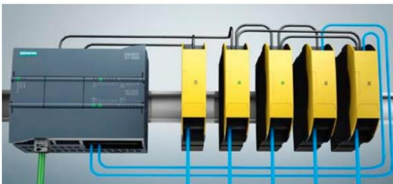
Obr. 68) a) klasické PLC a bezpečnostné relé, b) bezpečnostné PLC [76]
