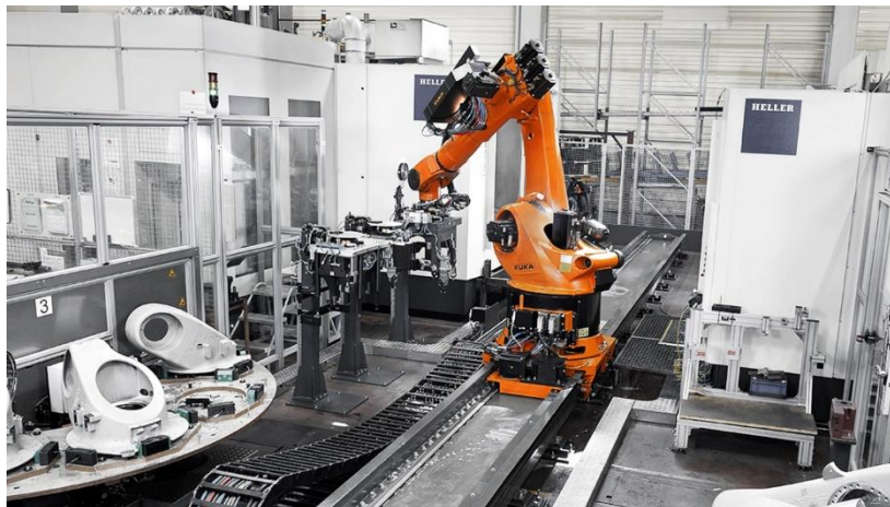
Obr. 1) RP s priemyslovým robotom Kuka s vlastným pojazdom [4]
