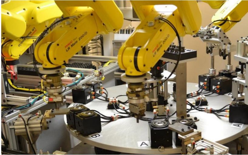
Obr. 38) Príklad RP pre montáž s niekoľkými priemyslovými robotmi [64]
