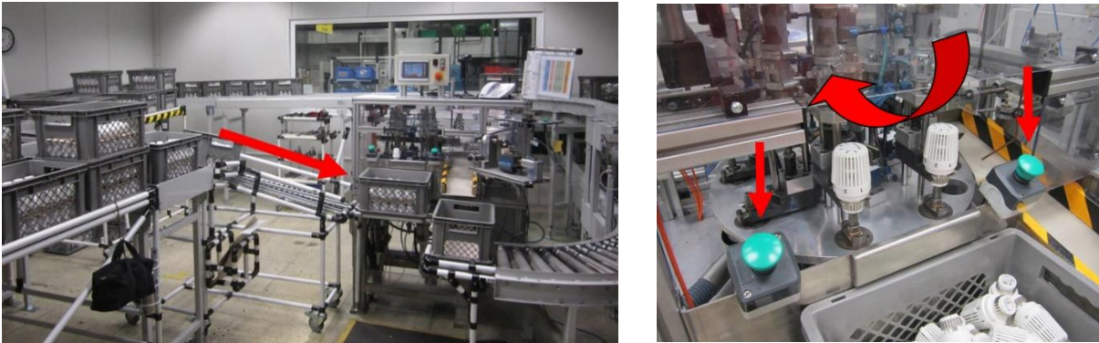
Obr. 42) a) Príjazd prepravky po dopravníkovej dráhe ku kalibračnému stroju, b) kalibrácia termostatických hlavíc v kalibračnom stroji [66]
