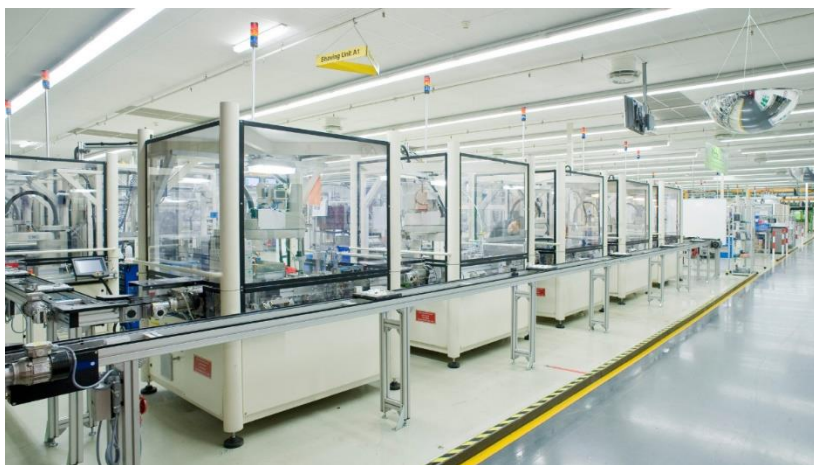
Obr. 2) Robotizovaný výrobný systém s medzioperačnou dopravou [5]
