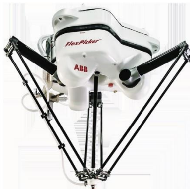
Obr. 9) Delta robot firmy ABB [16]
