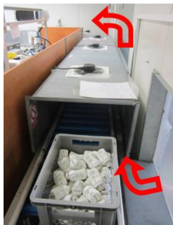
Obr. 41) Vstup prepravky s hlavícami do klimatizovanej miestnosti [66]
