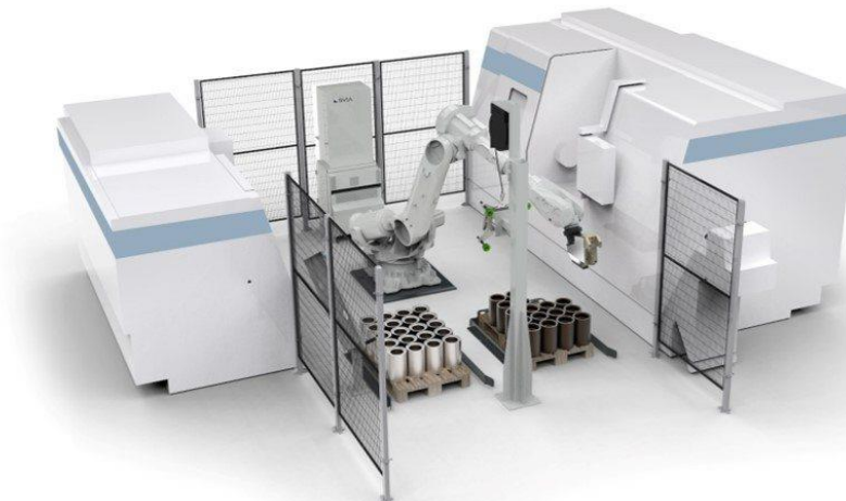
Obr. 36) Príklad RP s priemyslovým robotom pre zakladanie obrobkov do obrábacieho stroju [59]
