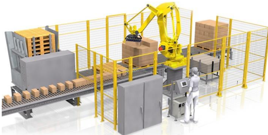
Obr. 34) Príklad RP so šesťosím robotom pre manipuláciu s materiálom [57]
