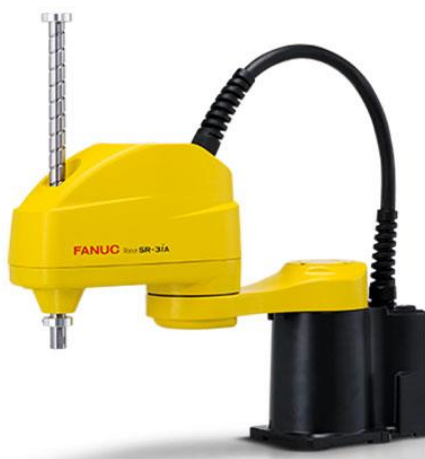
Obr. 8) SCARA robot firmy Fanuc [14]
