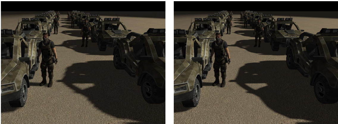
(a) Při velmi nízkém rozlišení lze vidět alias stínové mapy, i když je použito filtrování. (b) Stínová mapa bez aliasu při použití vyššího rozlišení.
