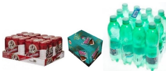
Obr. 1.15 – Manipulační jednotka 1. řádu
