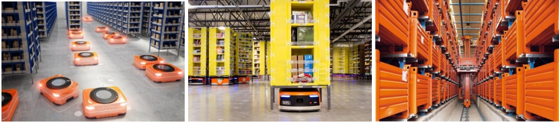
Obr. 1.23 – Plně automatizované manipulační prostředky
