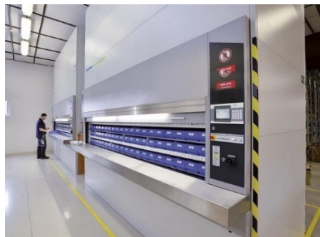
Obr. 1.13 – Plně automatizovaný rotační regál
