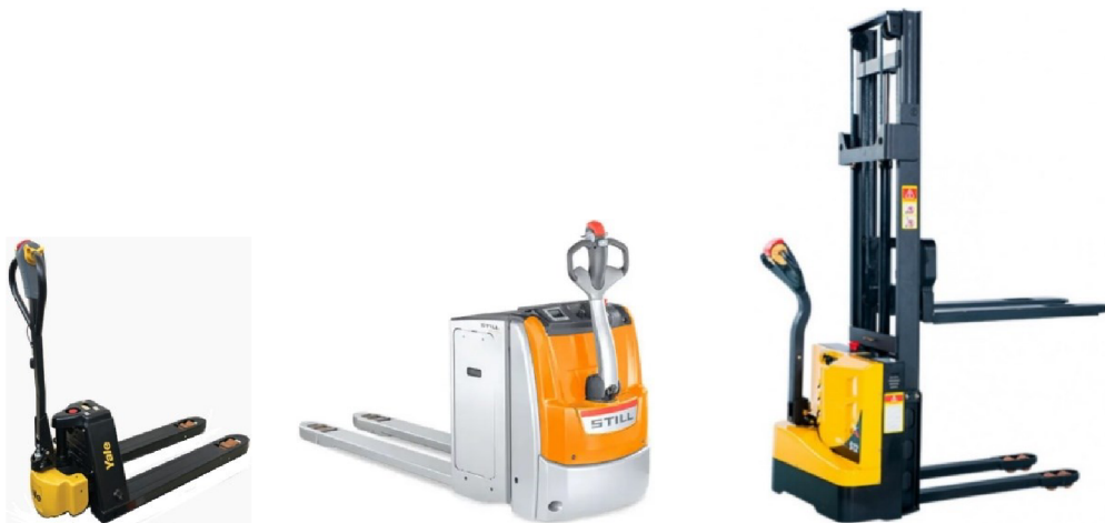
Obr. 1.21 – Paletový vozík el., nízkozdvihový vozík el., vysokozdvihový vozík el.
