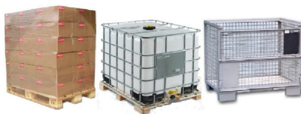
Obr. 1.16 – Manipulační jednotka 2. řádu
