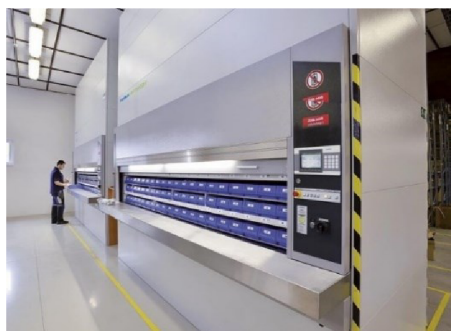
Obr. 1.13 – Plně automatizovaný rotační regál
