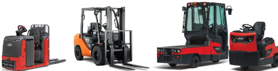
Obr. 1.22 – Nízkozdvihový, vysokozdvihový a plošinový vozík, tahač
