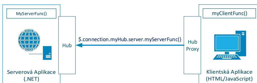
Obrázek 3.2.: SignalR Huby - volání metody na serveru z klienta. Zdroj: [12]
