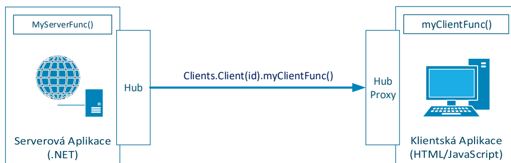
Obrázek 3.1.: SignalR Huby - volání metody klienta ze serveru. Zdroj: [12]
