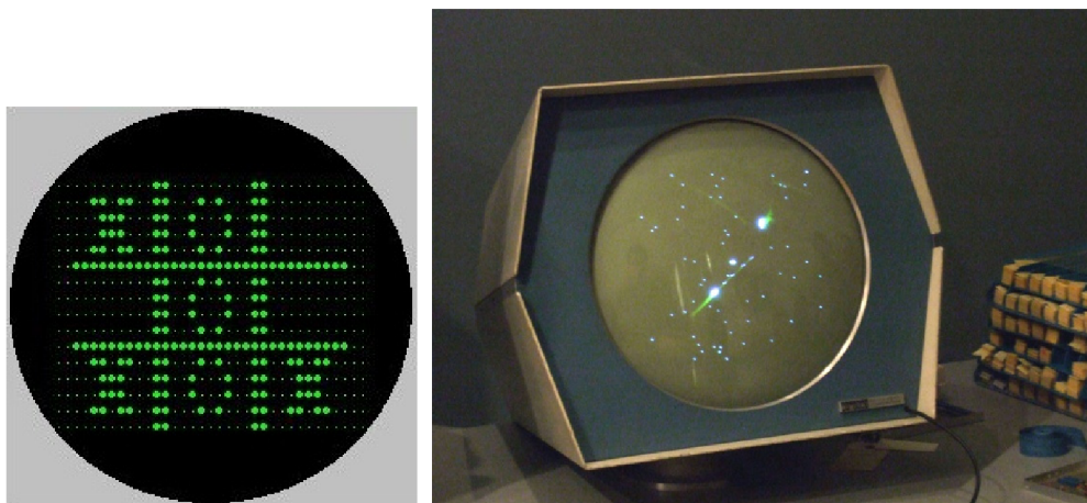
Obrázek 2.1: Vlevo grafický výstup hry OXO, vpravo vektorový zobrazovací systém s hrou Spacewar!
