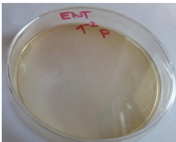
Obrázek 12 - Petriho miska s půdou COMPASS Enterococcus Agar inkubovaná při 44 °C/1 den: enterokoky nejsou přítomny
