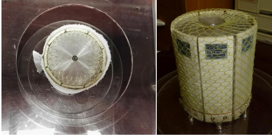
Obr. č. 11 a č. 12: Náhledy na vyhřívá váleček osázený alfametry (A0-A7).[43]
