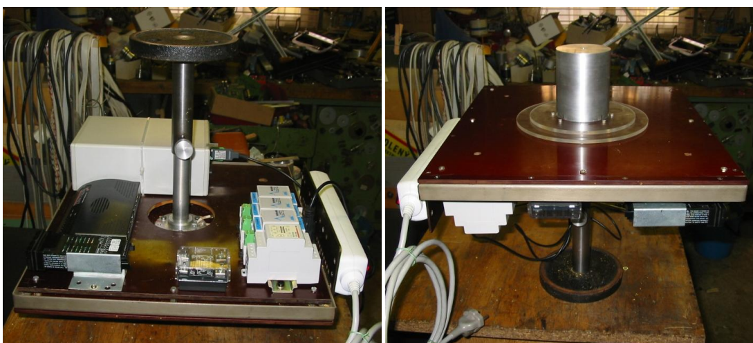
Obr. č. 6 a č. 7: Zapojení elektronického řízení větrného tunelu- komunikační linky, umístěné pod podstavcem vyhřívaného válečku. [43]
