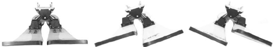
Obrázek č.13 – Náklony lyží pomocí kloubu (Anonymous 3, n.d.)
