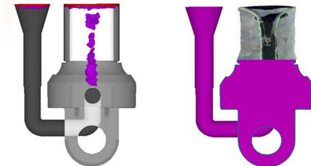
Obr. 8 Reálný odlitek vpravo potvrzuje správnost predikce staženiny [4]
