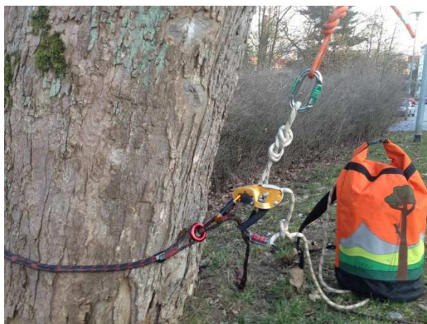
Obr. 14.: Spouštěcí systém pro výstupové lano, za použití dvou lan
