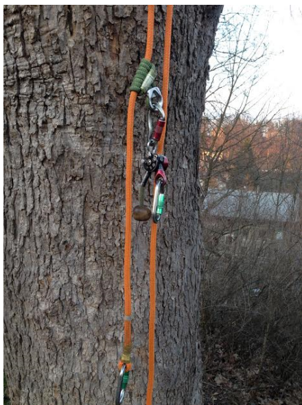
Obr.17.: Přizvednutí zraněného stromolezce pomocí DRT, před přizvednutím
