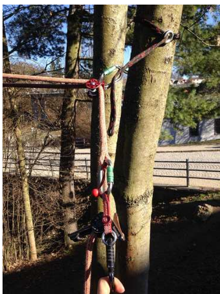
Obr. 33.: Přesměrování s dvojkładkou, s využitím větvení, bez možnosti demontáže
