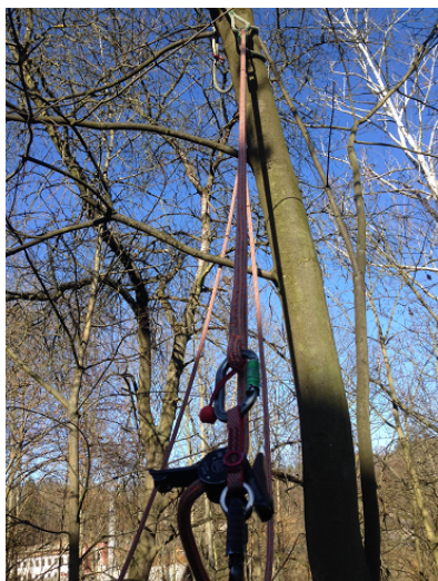
Obr. 36.: Změna směru vedení pracovního lana I.
