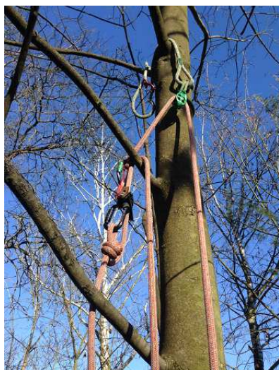
Obr. 38.: Změna směru vedení pracovního lana III.
