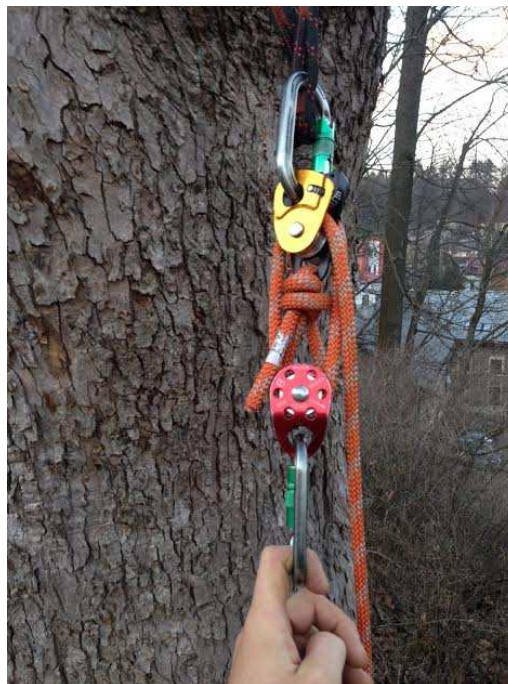
Obr. 20.: Kladkostroj k přizvednutí zraněného s kladkou a blokantem Jag Traxion, po přizvednutí
