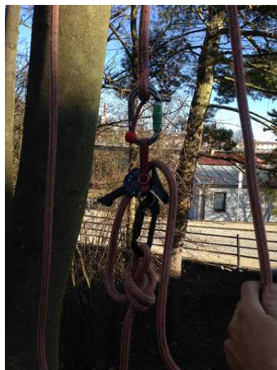
Obr. 37.: Změna směru vedení pracovního lana II.
