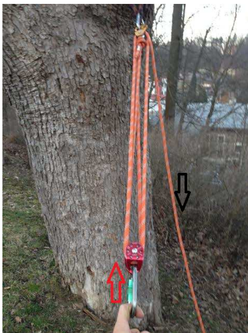
Obr. 19.: Kladkostroj k přizvednutí zraněného s kladkou a blokantem Jag Traxion, před přizvednutím
