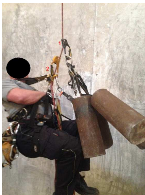
Obr. 22.: Záchrana z výstupového lana bez možnosti využití jiných přístupových cest I. 1-blokant se závažím, simulujícím hmotnost zraněného lezce, nad jištěním zachraňujícího lezce, 2- blokanty zachraňujícího lezce
