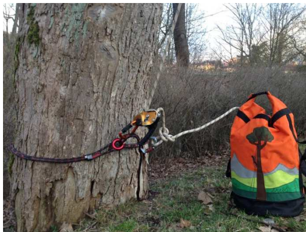
Obr. 13.: Spouštěcí systém pro výstupové lano, za použití jednoho lana
