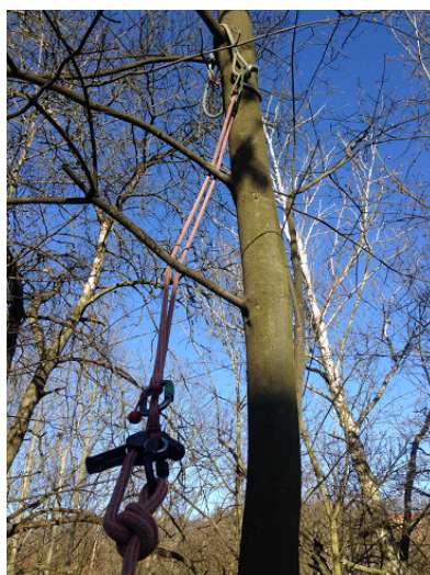
Obr. 39.: Změna směru vedení pracovního lana IV.
