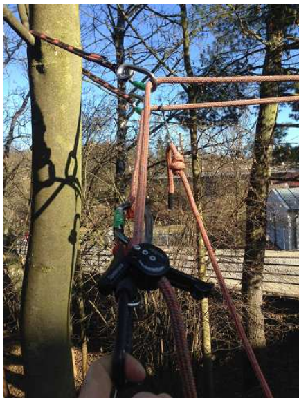
Obr. 35.: Přesměrování za využití dvou karabin s možností demontáže během záchrany
