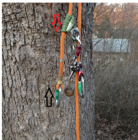
Obr.18.: Přizvednutí zraněného stromolezce pomocí DRT, po přizvednutí
