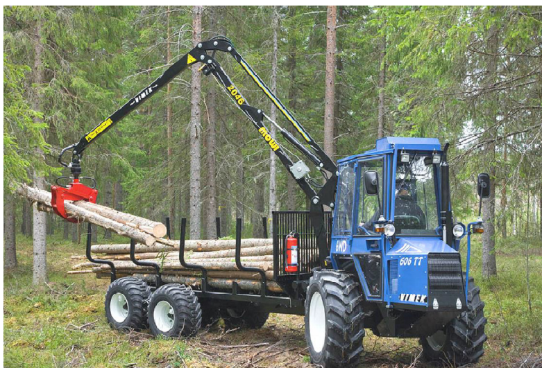
Obr. 5.: Vyvážecí traktor Vimek 606 TT (Anonymous 2015)
