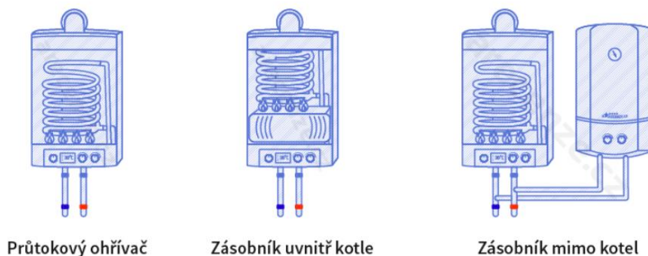
Obrázek 2.9 Rozdělení plynových kotlů k ohřevu vody [30]
