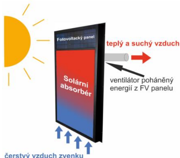
Obrázek 2.22 Princip teplovzdušného solárního vytápění [78]
