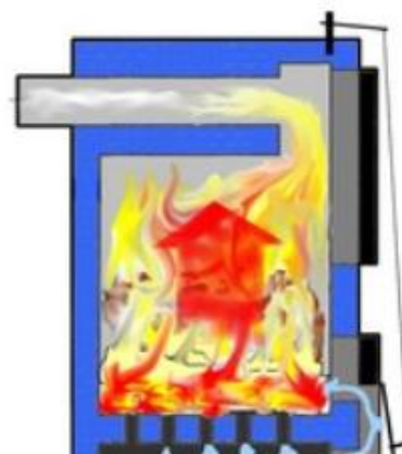
Obrázek 2.4 Schéma prohořivacího kotle [16]
