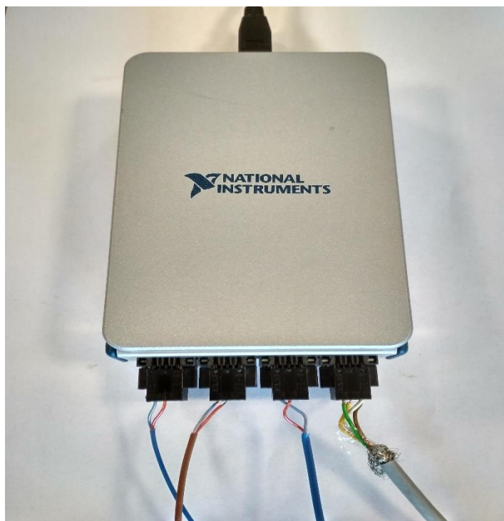
Obrázek 19 Šasi National Instruments CDAQ - 9219
