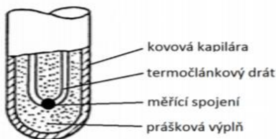
Obrázek 15 Plášťový termočlánek [18]
