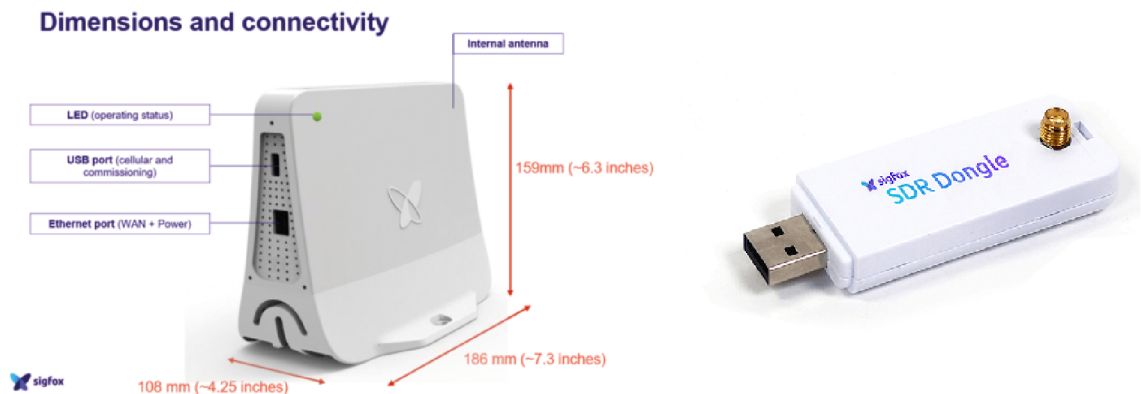
Obr. 4.1: Zariadenia pre zvýšenie pokrytia, zdroj: [24]
