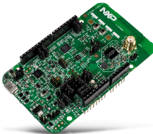
Obr. 7.1: Vývojová doska FRDM-KW41Z, zdroj: [17]
