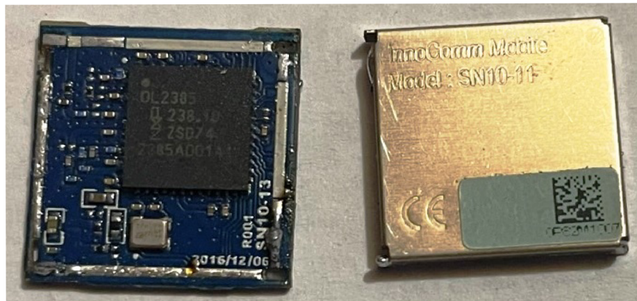
Obr. 6.9: Vnútro modulu SN10-11
