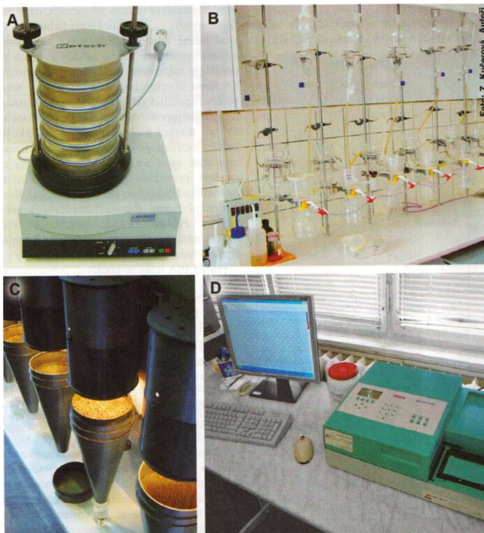
Obr. 9 Přístrojové vybavení pro detekci kontaminace skladovaných substrátů roztoči, A - laboratorní prosévačka Retsch A5 200 digit; B - Tulgren-Berleseho přístroj pro tepelnou a světelnou extrakci roztočů; C filth flotační aparatura; D - ELISA reader (thermo) pro měření absorbance ELISA testů (Křížková-Kudlíková a kol., 2009).
