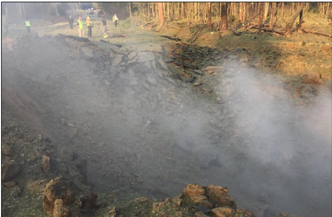
Obr. 20 Hluboký kráter na dálnici v jižním Arkansasu po explozi nákladního vozidla převážejícího dusičnan amonný v roce 2019 Zdroj: Snyder a Rddad (2019)
