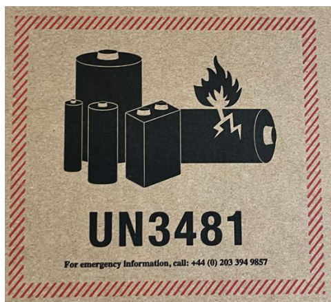
Obr. 6 Označení lithium-iontové baterie na papírové krabici – UN číslo 3481 Zdroj: autorka (2023)
