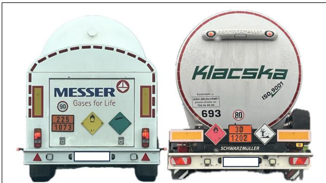
Obr. 8 Příklady použití oranžové výstražné tabulky na cisternovém vozidle s UN číslem 1073 (vlevo) a 1202 (vpravo) Zdroj: autorka (2024)
