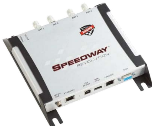
Obrázek 1: Stacionární čtečka Impinj R420 Speedway Revolution [10]
