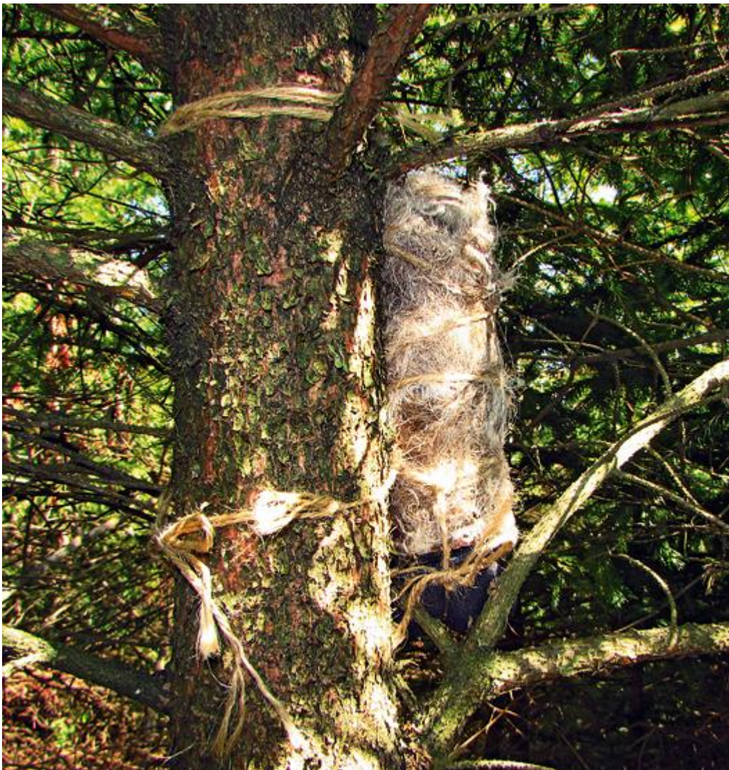
Obr. 17: Nahrávací zařízení umístěno v ochranném obalu, připevněné na stromě. Fotografie převzata v nezměněné podobě z 2. čísla časopisu Živa vydaného v roce 2018. Autorem fotografie je Tomáš Krajča.
