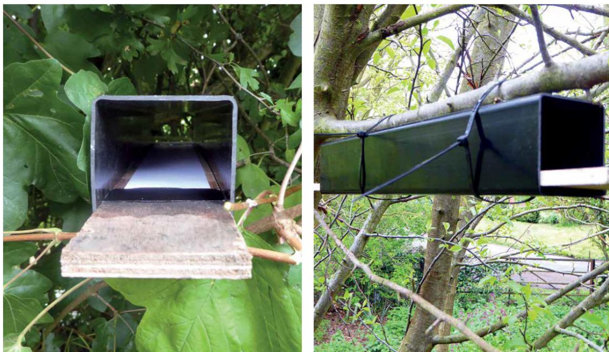
Obr. 1: Otiskové tubusy, zakoupené v obchodě, kde můžeme vidět proužek s inkoustem a papír, na který se obtiskují stopy. Fotografie převzata z článku Bullion et al., 2018.
