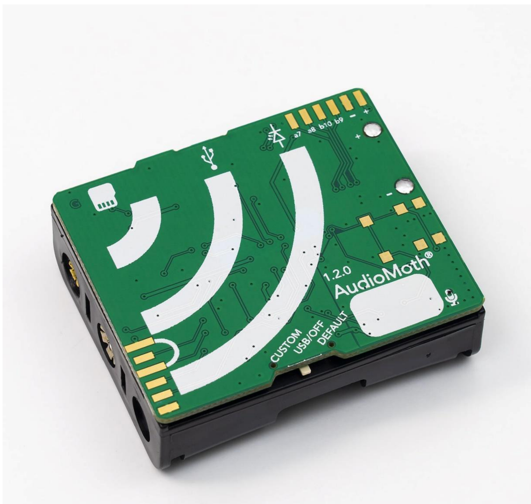
Obr. 15: AudioMoth, celospektrální akustický záznamník. Fotografie převzata v nezměněné podobě z webu https://www.openacousticdevices.info/audiomoth
