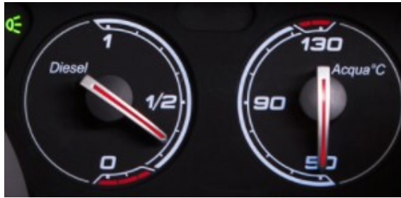
Obrázek 24- Slovní popisy v italském jazyce na palivoměru a teploměru bez použití symbolu
