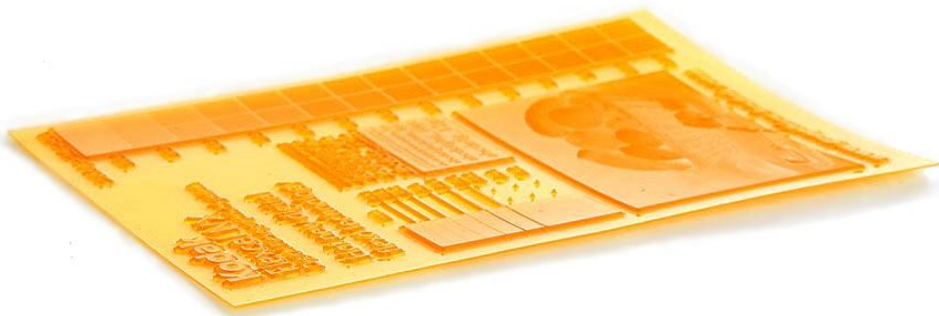
Obr. 2.3 Tisková deska ve formě rovinného štočku [4]
