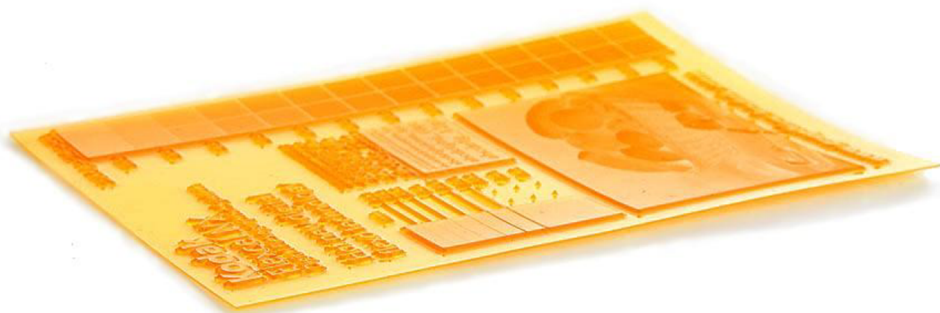
Obr. 2.3 Tisková deska ve formě rovinného štočku [4]
