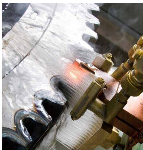
Obr. 21 Indukční povrchové kalení [12]
