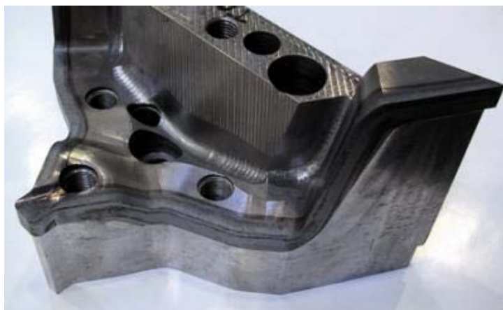
Obr. 23 Příklad zakalené hrany střižného nástroje [21]
