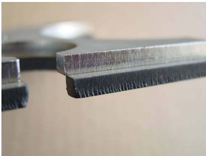
Obr. 14 Kvalita plochy řezu při řezání kyslíkem (spodní díl) a dusíkem (horní díl) [24]
