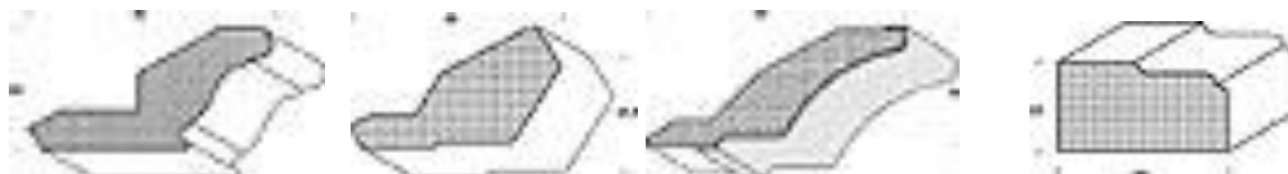
Obr. 13: Profilové věnce a lemovky v řezu (2)
