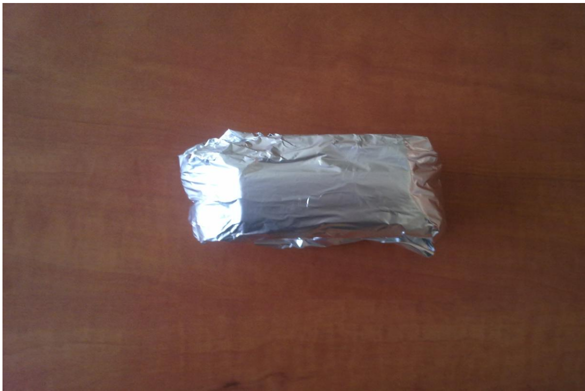
Foto Autor – test rušení přenosu vysílače magnetického kontaktu hliníkovou fólií
