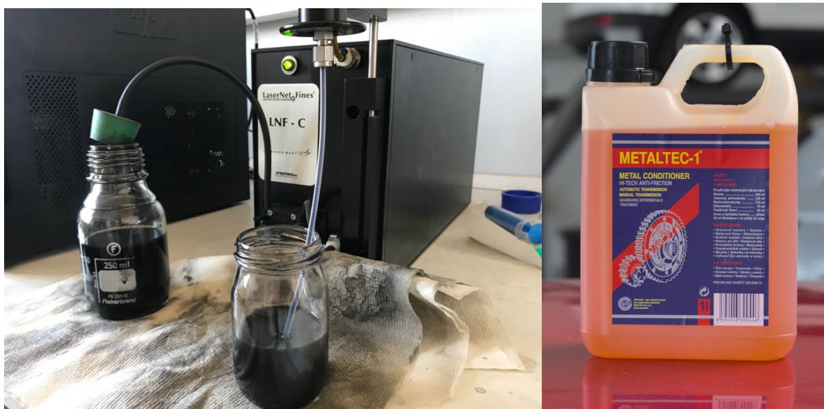
Obrázek č. 23: Částicový analyzátor LaserNet Fines LNF-C katedry jakosti a spolehlivosti strojů (vlevo) a aditivum METALTEC-1® (vpravo) [autor]
