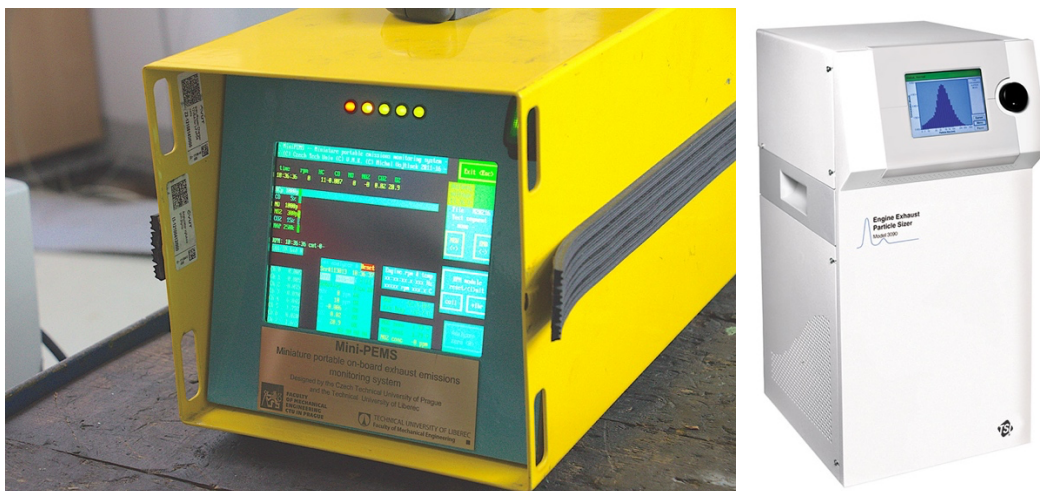
Obrázek č. 17: Zařízení Mini-PEMS vytvořené ve spolupráci ČVUT a TUL (vlevo) [autor] a analyzátor pevných částic TSI EEPS 3090 (vpravo) [36]
