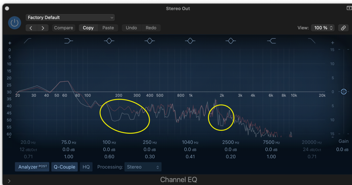
Obrázek č. 22: Analýza nahrávky nástrojem EQ se žlutě vyznačenými poklesy hlasitosti v určitých frekvencích. Červená křivka je běžná nafta Efecta diesel, bílá křivka je stav po použití aditiva a prémiové nafty [autor]
