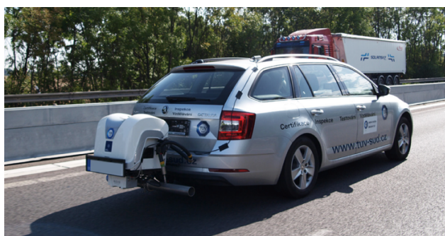
Obrázek č. 10: PEMS upevněné na tažném zařízení testovaného vozu při měření RDE [33]
