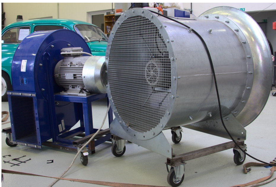
Obrázek č. 20: Dvojice ventilátorů potřebných pro chlazení při měření výkonu. Filcar AL-A1500/C (vlevo) a VENTRA ALM-800-3 (vpravo) [autor]
